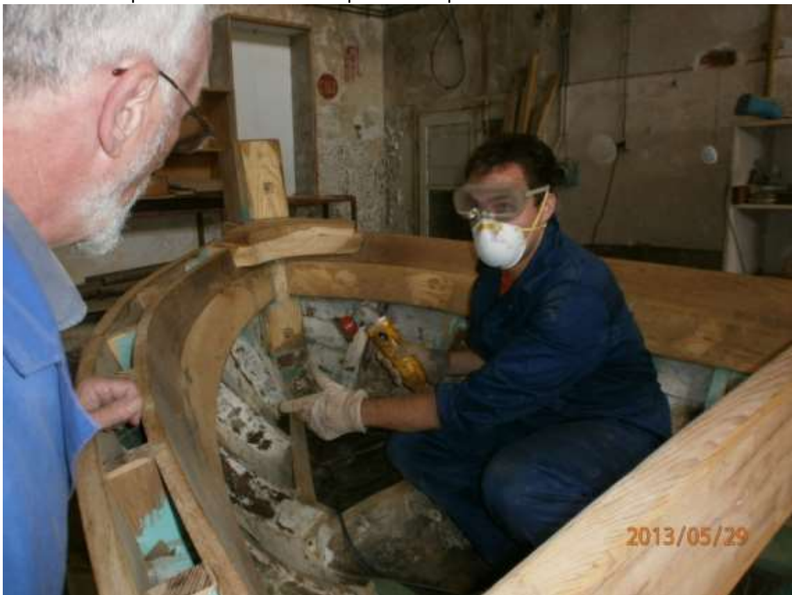
Sl. 19 Davor je sa Grišom naučio brušenje spojeva
