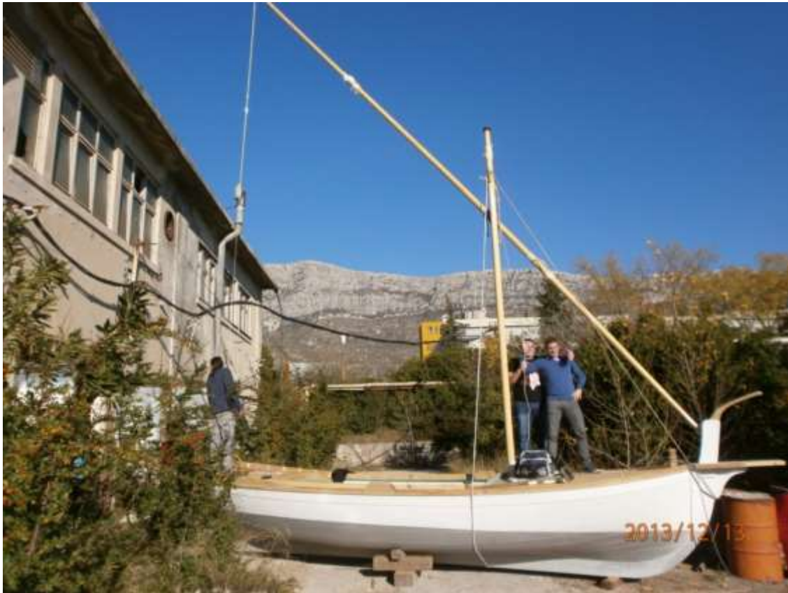
Sl. 27 Brod smo izvukli iz radione te s Damikom i Nevenom izvršili mjerenje pozicije lantine i odredili dimenzije jedra
