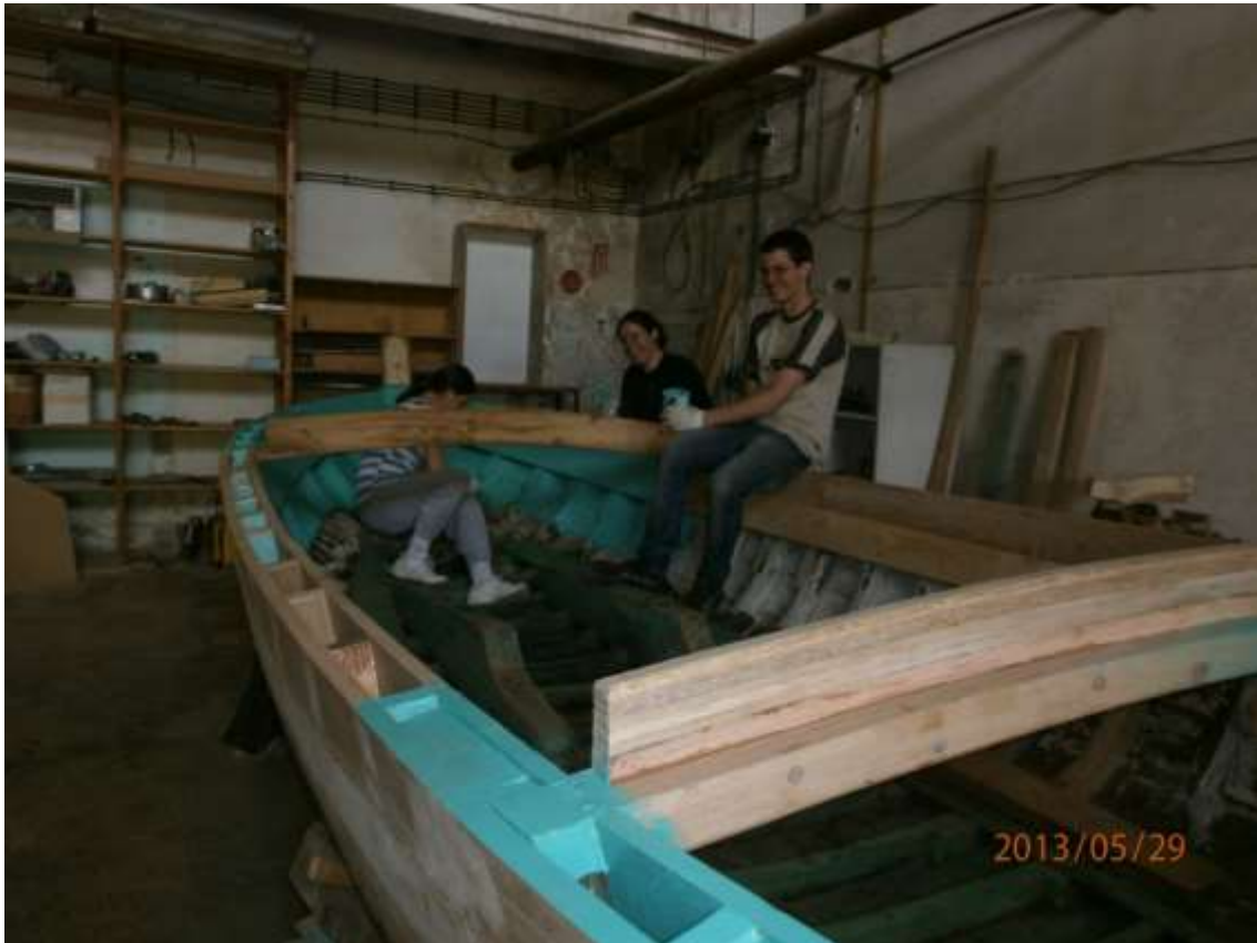
Sl. 20 ...pa smo onda sve očistili i dovršili bojanje unutarnjeg dijela krme
