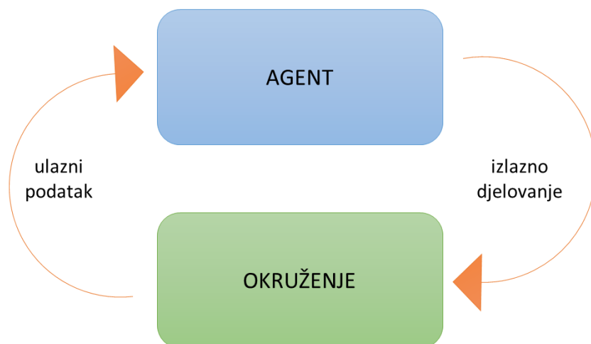
Slika 1. Agent u svom okruženju. Agent uzima ulazni podatak iz okruženja i pretvara ga u izlazno djelovanje usmjereno na okruženje. Interakcija je obično neprekidna
