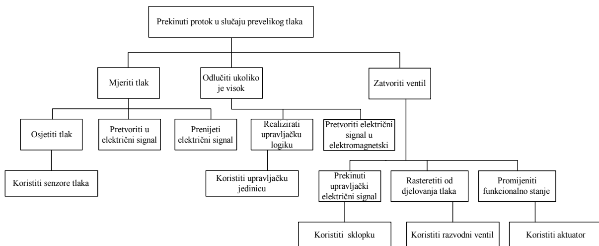
Slika 9. Funkcionalno stablo SIS sustava za zatvaranje ventila u slučaju nužde.
