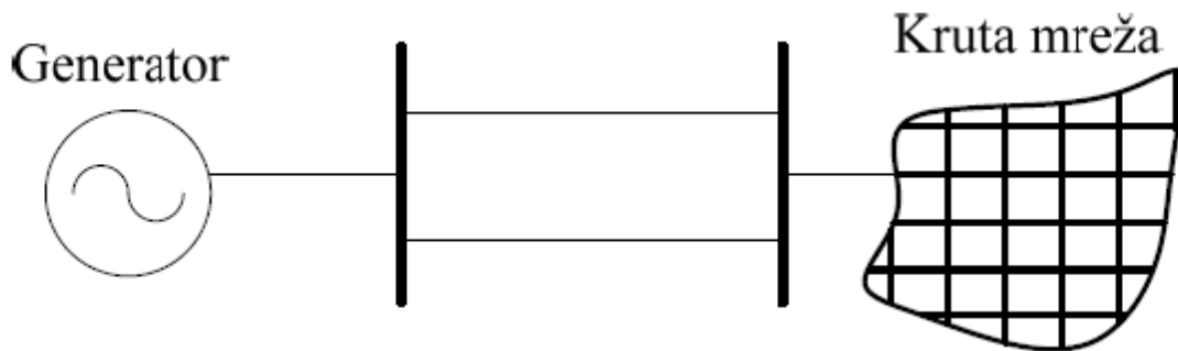
Slika 5.3. Jednopolna shema trofaznog generatora koji je preko transformatora i dvostrukog dalekovoda priključen na sabirnice krute mreže
